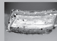
目立て前 ダイヤ砥粒の後方にラインがない
