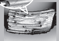
目立て後 ダイヤ砥粒の後方にラインがある
