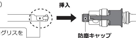
**注** センタードリルのシャンク挿入部にグリスを塗布してください。センタードリルのL型溝の変形が軽減されます。L型溝に変形が見られるものは、穿孔中に外れる危険があるので使用しないでください。
