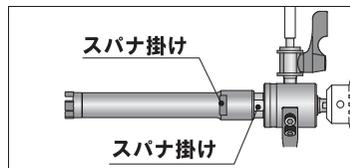
2 カッターを交換する場合は、ボディのスパナ掛けにスパナを掛けてプライヤー又はペンチでカッターを回して取り外してください。
