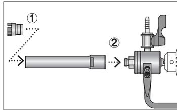
2 **注意：**ボディを取り付ける場合は、水量調整バルブを開けておいてください。各種給水装置からのホースを繋いだ状態でバルブが開いていますと、水が出ます。
