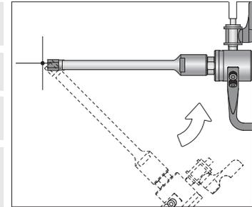
※小径(特に刃先径4～5mm)のカッターの場合は破損する恐れがありますので、下記Cの位置決めガイドを使用されることをおすすめします。
