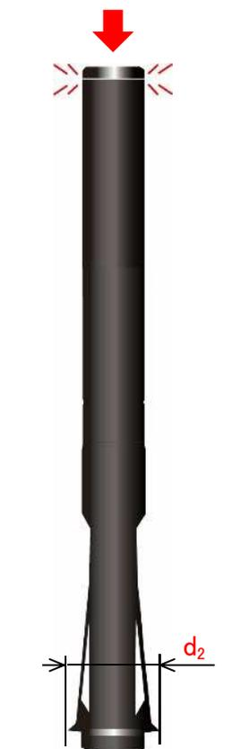
図 2-7 拡底確認ゲージ使用前準備参考図
