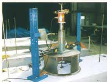
引抜き耐力確認試験
