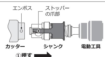
2 カッターのエンボス(丸型凸部)をシャンクのストッパーの爪部に合わせ、そのままカッターをシャンク側(矢印①)に押してください。
