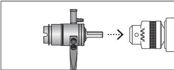
**2** ①カッターをボディに取り付け、②ボディをシャンクの取付部に挿入してください。
