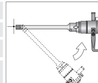
※小径(特に刃先径4～5mm)のカッターの場合は破損する恐れがありますので、下記Cの位置決めガイドを使用されることをおすすめします。
